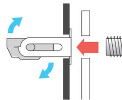
ターンナットを下穴に挿入した後に器材をあてがい、ねじを指で差し込みます。ねじを軽く押すと、ナットが回転します。
