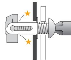
ハンドドライバーでねじを押しながら1~2回逆転させ(左回り)、そのまま2~3回正転させてねじを軽くねじ込みます。
