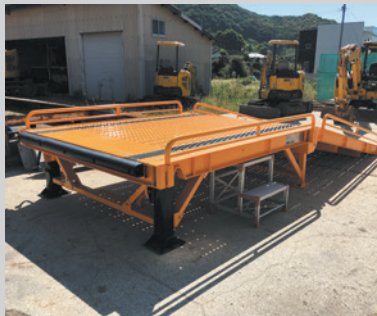
▶ 建機昇降用スロープ
