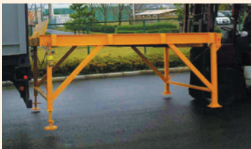
架台1をコンテナに接続
