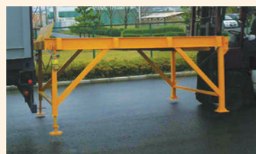
架台1をコンテナに接続 (注) フォークリフトにて上図のように架台1・2・3をセットする場合は、荷重2000kg/容量、爪の長さ1650mm以上のリフトをご利用ください
