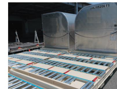
貨物コンテナ用コンベア架台
