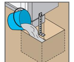
●土の上ならコンクリートを打ち込んで4箇所固定して下さい。
