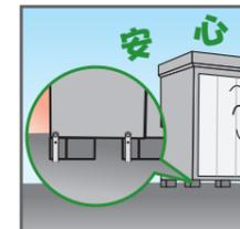
●強風で転倒しない様に、付属のアンカープレートまたは転倒防止金具で、本体を固定して下さい。
