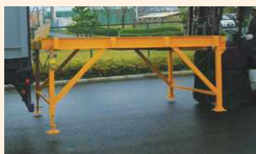
架台1をコンテナに接続
