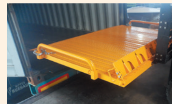
スロープのぼり口に爪の差し込み口があります。
