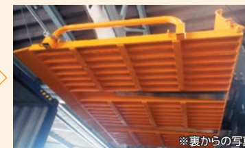
爪を差し込み押し上げコンテナと接続。
