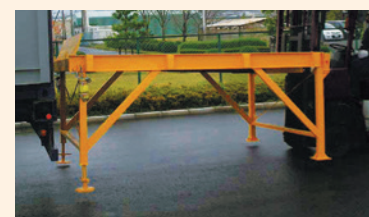
架台1をコンテナに接続
